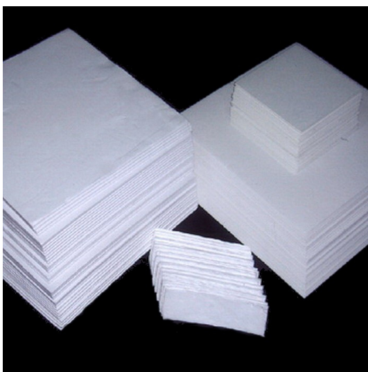
Obr. 27 – přířezy ze skelného rouna pro výrobu separátorů AGM akumulátorů
