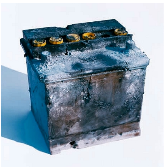
Obr. 30 – poněkud zanedbaný akumulátor
