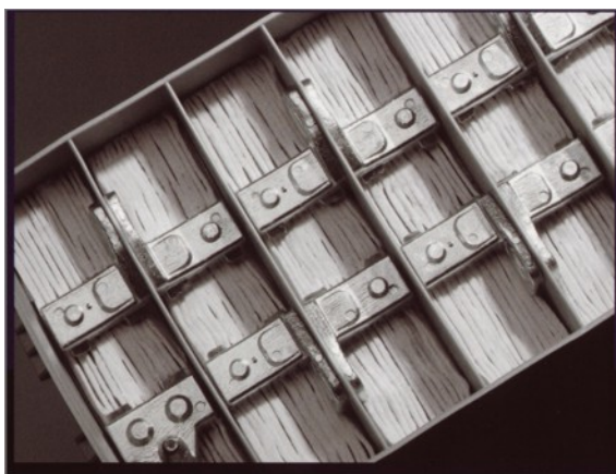
Obr. 4 – pohled pod víko do akumulátoru
