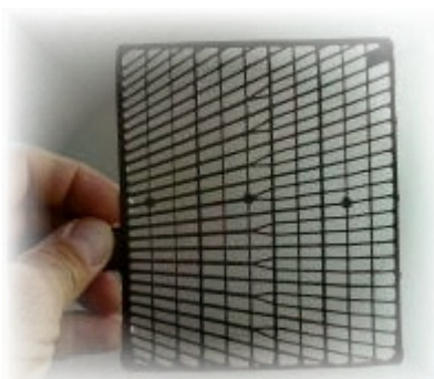
Obr. 16 – plochá mřížka akumulátoru
