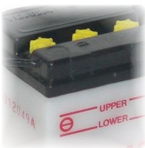
Obr. 32 – typické provedení údržbového akumulátoru. Zátky pro dolévání destilované vody, odvětrací hadička, kontejner z mléčného, poloprůhledného plastu umožňující inspekci hladiny elektrolytu, s vyznačením minimální a maximální hladiny.
